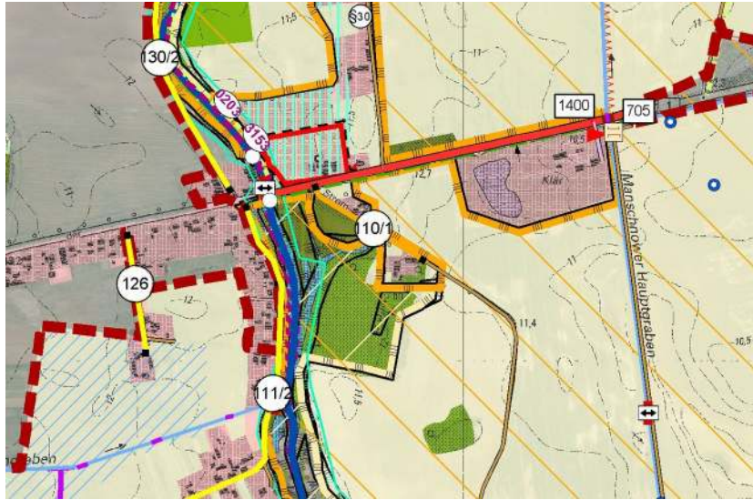
Länge: 275 m, Ausbaubreite: 2,00 m, Ausbauart: Spurbahn Beton
